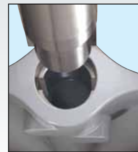
Conexión del disco al vástago de doble cuña
